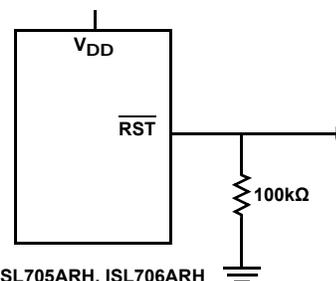
FIGURE 17.  $\overline{RST}$  VALID TO GROUND CIRCUIT
